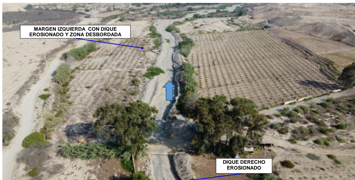
FIGURA N°03: QUEBRADA PISQUILLO ORCÓN, CON LOS DIQUES DE AMBOS LADOS EN ESTADO DE EROSION AVANZADA, CAUSE COLMATADO DE FLUJO DE DETRITOS Y LA TROCHA CARROZABLE PALPA - ORCON - PACAYBAMBA.
